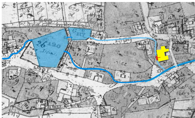
Č.p. 26. Mlýnské kolo bylo vlevo z boku roubené stavby. Vpravo výřez mapy katastru z roku 1839 se zakresleným potokem přes dnešní rybník. Druhá menší nádrž je těsně pod rybníkem a z ní vychází náhon ke mlýnu. Červeně je naznačeno mlýnské kolo. Z hlavní silnice vychází ulička podél mlýna a napojuje se přes most přes potok na spodní ulici.
